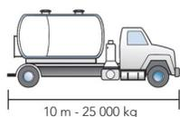
Le camion régulier a besoin d'un passage d'au minimum 3,5 m de largeur et 4 m de hauteur.
